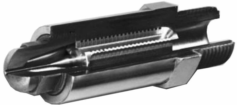
過濾咀有助於除去塑膠材料中的金屬屑及夾雜物。採用此種方法可以避免當熱膠道系統阻塞時需停機清除而造成的不便及損失。
